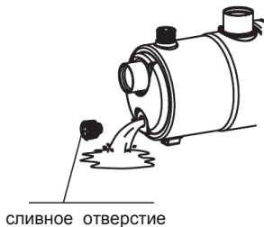
Рис.6 - Перед первым запуском корпус насоса необходимо заполнить водой
